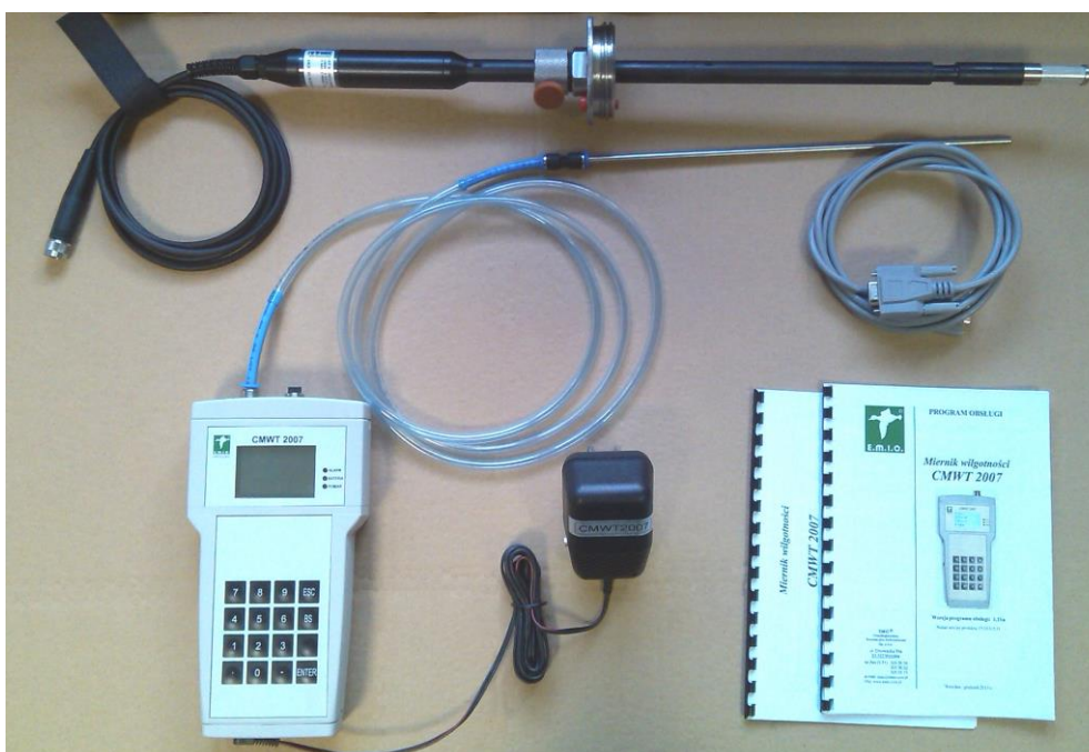
Cyfrowy miernik CMWT 2007 z wyposażeniem
