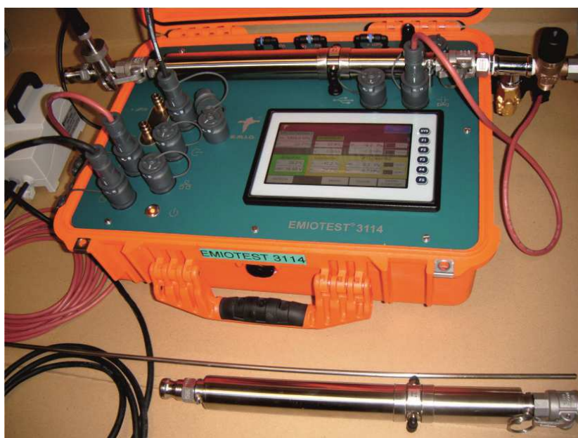
Jednostka sterująca pyłomierza typu EMIOTEST 3114
